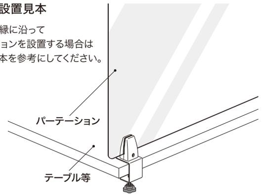
固定器具タイプAのホルダー部分は、設置方法に合わせて取り付ける方向を変更することができます。
