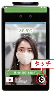
製品が起動してしばらくすると温度測定の画面が表示されます。画面右下の歯車マークを押してください。設定を変更することができます。
