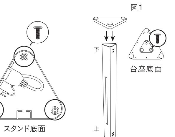
①スタンドを上下逆にして、底面の裏側についているネジを、ドライバーを使用して取り外します。
