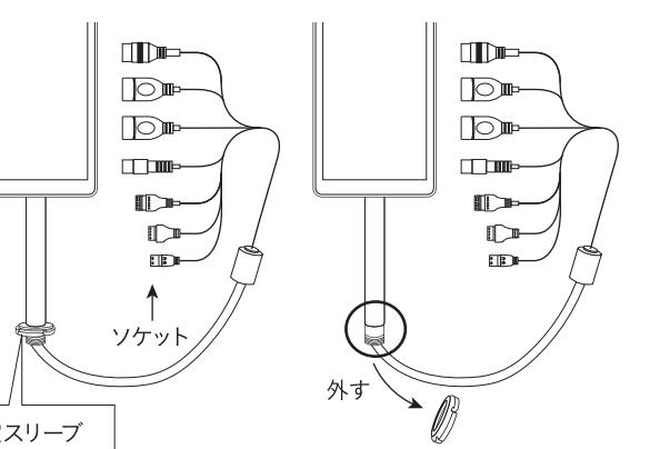
①ディスプレイのボルト部分にある、固定スリーブを回して緩めます。
