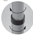
上側のポールを右にねじりながら、 下側のポールは左にねじり、 ポール同士がしっかりときつくお互いが 固定されるように、固く締め付けてください。 ここの締め付けが緩いと、使用中に 上側のポールが下側のポール内へ 落下してしまう場合があります。
