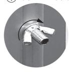
上下2箇所の蝶形ナットを右に回して、 しっかりときつく締め付けてください。 ここを固く締め付けていないと、 看板の固定が緩くなり、
