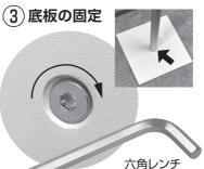
底板の裏側からポールを 固定している六角ネジを、 付属の六角レンチでしっかりと 右へまわして締め付け 固定をしてください。 締め付けが緩い場合、 ポールが不安定になります。
