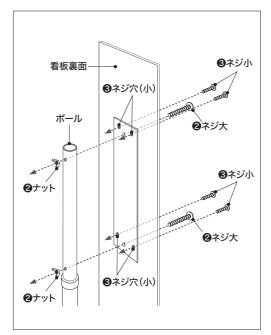
◆ネジ小の固定箇所に、「測定センサー」「オートディスペンサー」を引っ掛けて固定します。 引っ掛かりが甘いと、製品が落下するおそれがありますのでご注意ください。
