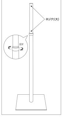
②看板のネジ穴(大)の箇所にポールのネジ穴 (大)を重ねます。ネジの頭を前面からはめ、 六角レンチで固定します。
