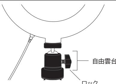
自由雲台のパーツのロックを回して緩めるとライトの角度を自由に調整いただけます。
